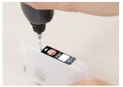
初回同様に、空気孔はゴム栓をしたままインク注入口のゴム栓を外してインクを注入します。
