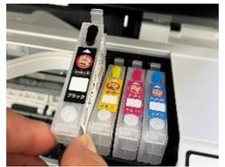
インク漏れを防止するために、カートリッジの空気孔にゴム栓を付けてからカートリッジを取り出します。
