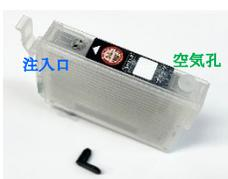
インク注入口のゴム栓を外します。このとき空気孔はゴム栓をしたままにします。
