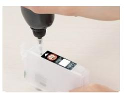
インク注入口にインクボトル先端のノズルを奥まで差し込みインクを注入します。カートリッジの約8分目までが注入量の目安です。インクを注入したら注入口にゴム栓を差し込みます。しっかりと差し込まないと、印字不良の原因になります。
