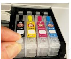
カートリッジをプリンターに「カチッ」と音がなるまでセットします。カートリッジをセットした後に空気孔のゴム栓を外し、ストップボタンを押すとインクの充填が始まります。※2回目以降も空気孔のゴム栓は使用するので、捨てずに保管します。
